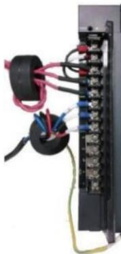
图 输入电源线与动力线加绕磁环
