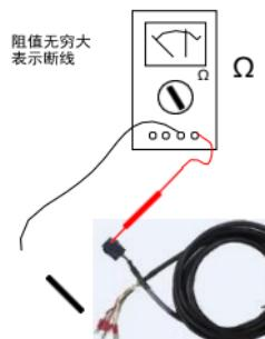
图 检测动力线缆是否断线
