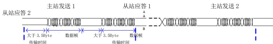
EV510E 系列驱动器内置的通信协议是 Modbus-RTD 从机通信协议，可响应主机的“查询/命令”，或根据主机的“查询/命令”做出相应的动作，并通讯数据应答。
