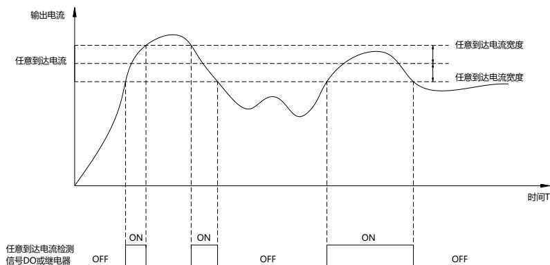
图 6-23 任意到达电流检测示意图
