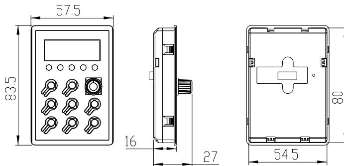
图 2-5 键盘操作器外形及安装尺寸图
