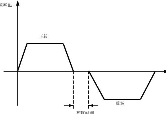
图 6-15 正反转死区时间示意图
