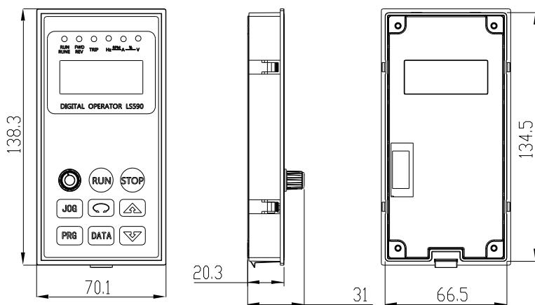
图 2-6 键盘操作器外形及安装尺寸图
