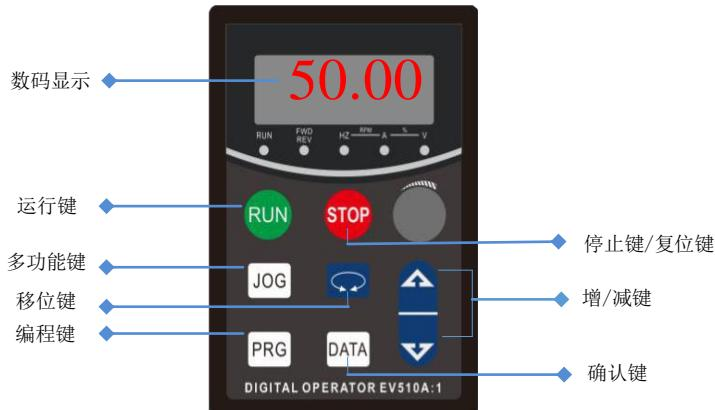
图 4-1 操作面板示意图
