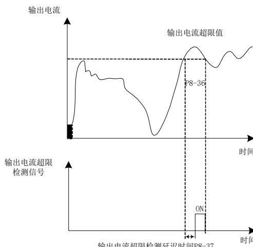
图 6-22 输出电流超限检测示意图
