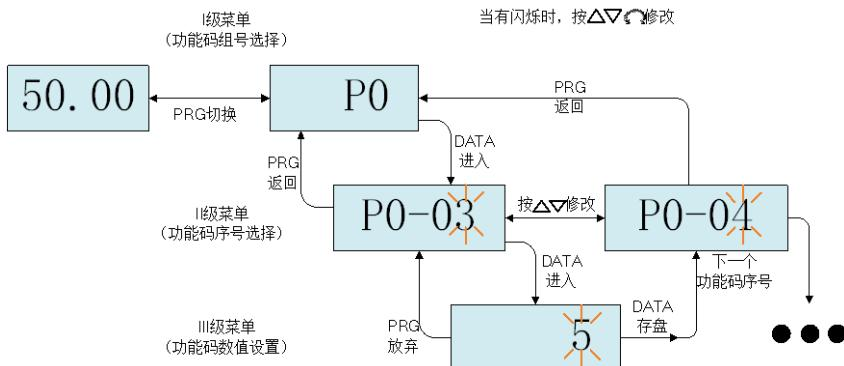
图 4-2 三级菜单操作流程图
