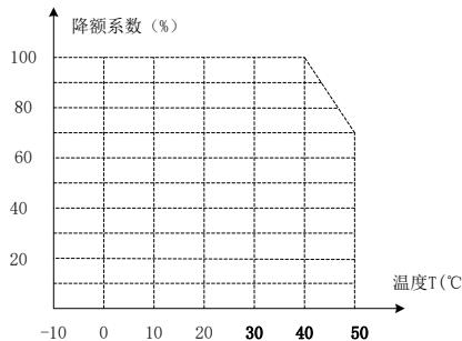
图 1-4 驱动器温度降额曲线图
