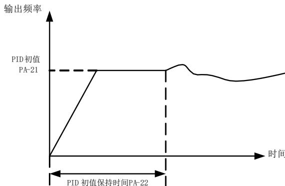
图 6-27 PID 初值的功能示意图
