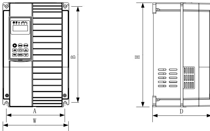
图 2-4 驱动器外形尺寸示意图
