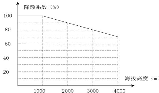
图 1-5 驱动器海拔高度降额曲线图
