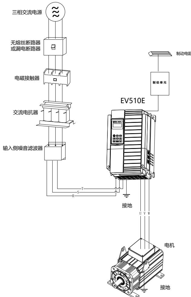
图 3-2 与外围器件连接示意图
