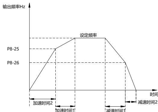
图 6-19 加减速时间切换示意图
