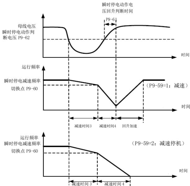
图 6-24 瞬时停电动作示意图
