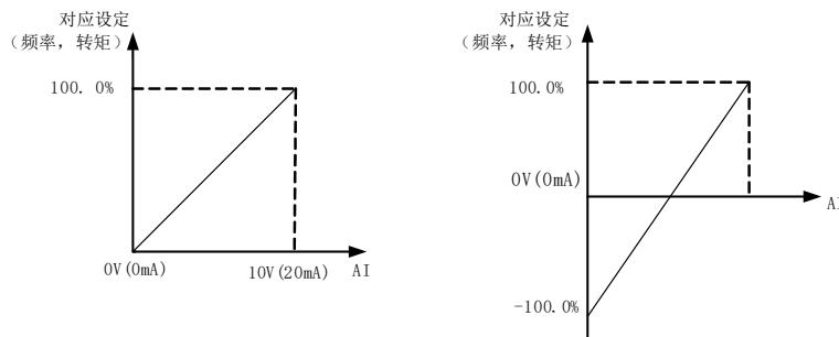
图 6-12 模拟给定与设定量的对应关系
