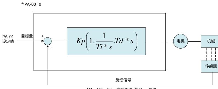
图 6-25 过程 PID 原理框图
