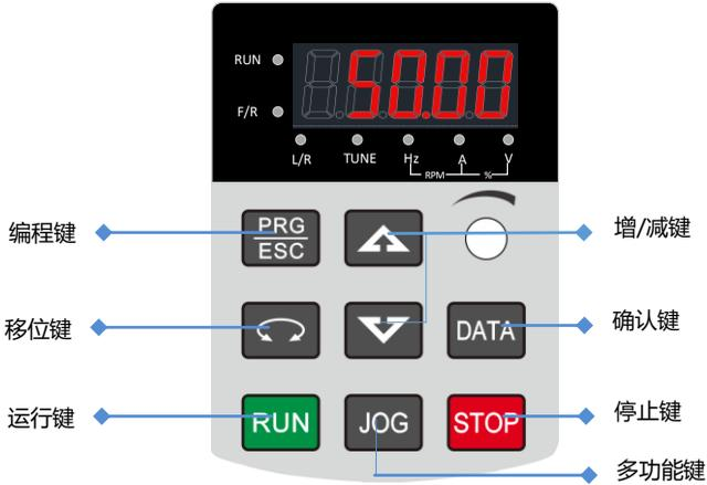
图 3-5 操作面板示意图
