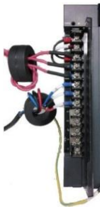
图 输入电源线与动力线加绕磁环
